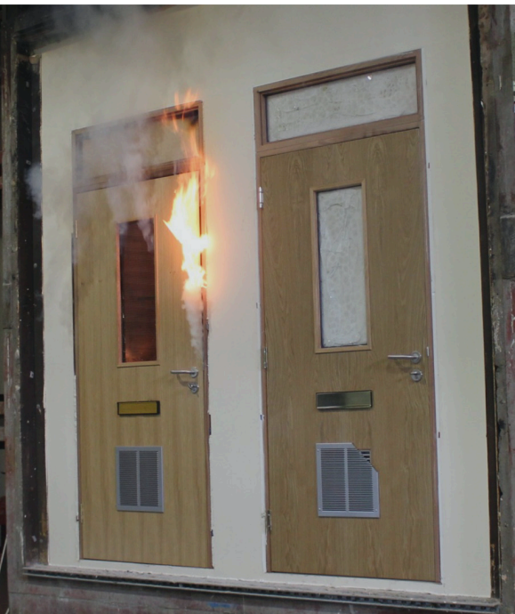
Fire door test
